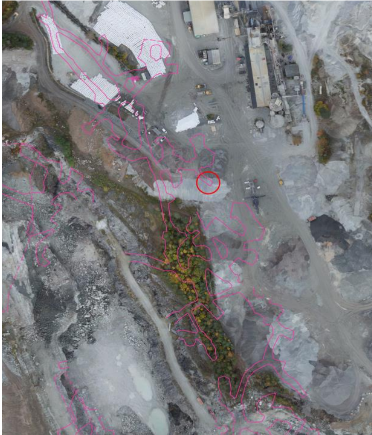
Figur 3: Röd ring visar placering av nuvarande sprängförråd, rosa färg visar hur tunnlarna sträcker sig i närområdet kring förrådet. (Bild källa: SMA Mineral Persberg AB, 2021-04-19).
