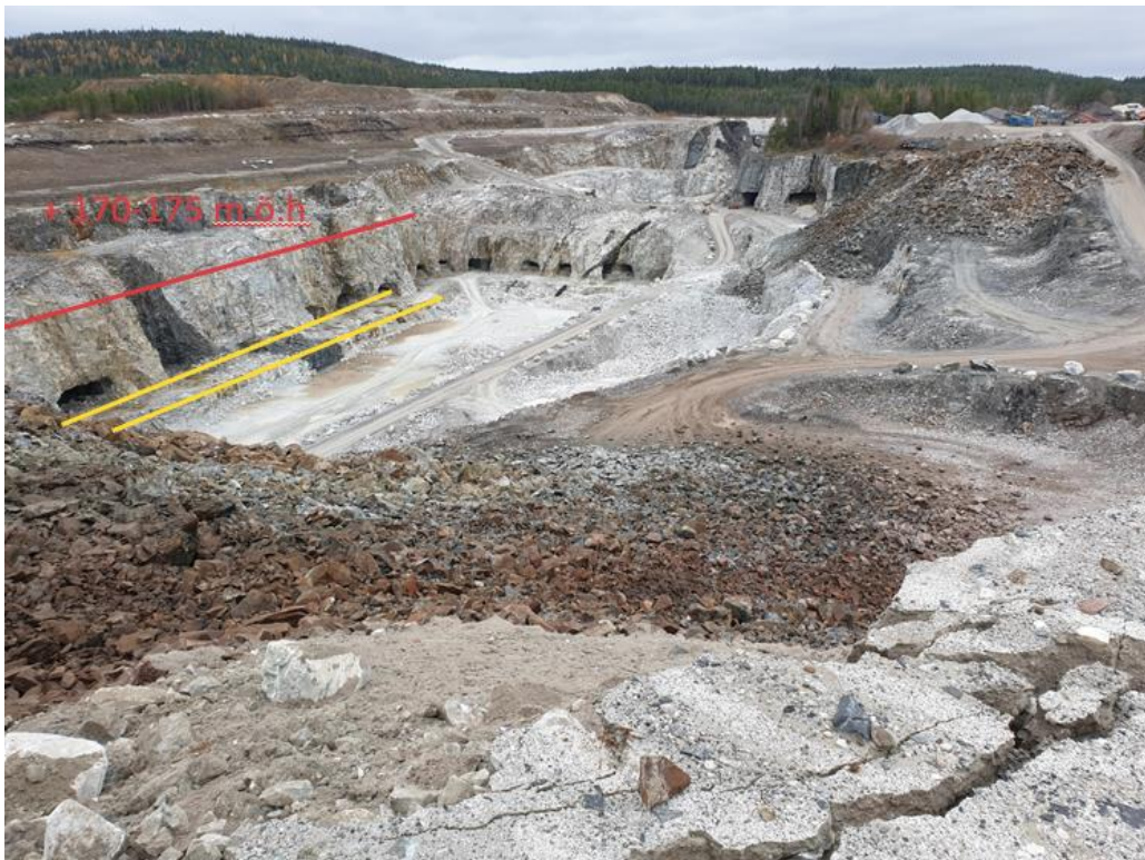
Figur 13: Röd linje visar ny tänkt pallkant, de två gula linjerna visar den pall som planerar att vidgas och användas för löpande underhåll. (bild källa: SMA Mineral Persberg AB, 2021-03-31).
