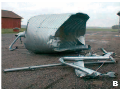
B. Delar av fodersilo som försetts med en filterpåse med otillräcklig filterkapacitet.
