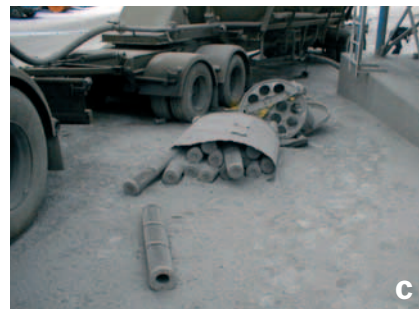
C. Filter som sprängts loss från silotaket och ramlat ned på marken.
