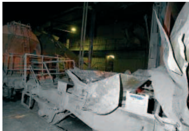
En "järnvägsbunkare", har trots sin kraftiga konstruktion, sprängts i bitar. En produkt som oväntat bildat gas, mellanlagrades i kärlet.
