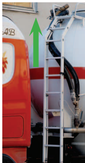
Avluftning direkt till fria luften är en teknik som borde bli standard i framtiden. Här har man valt att släppa ut luften över tanken respektive under chassiet.
